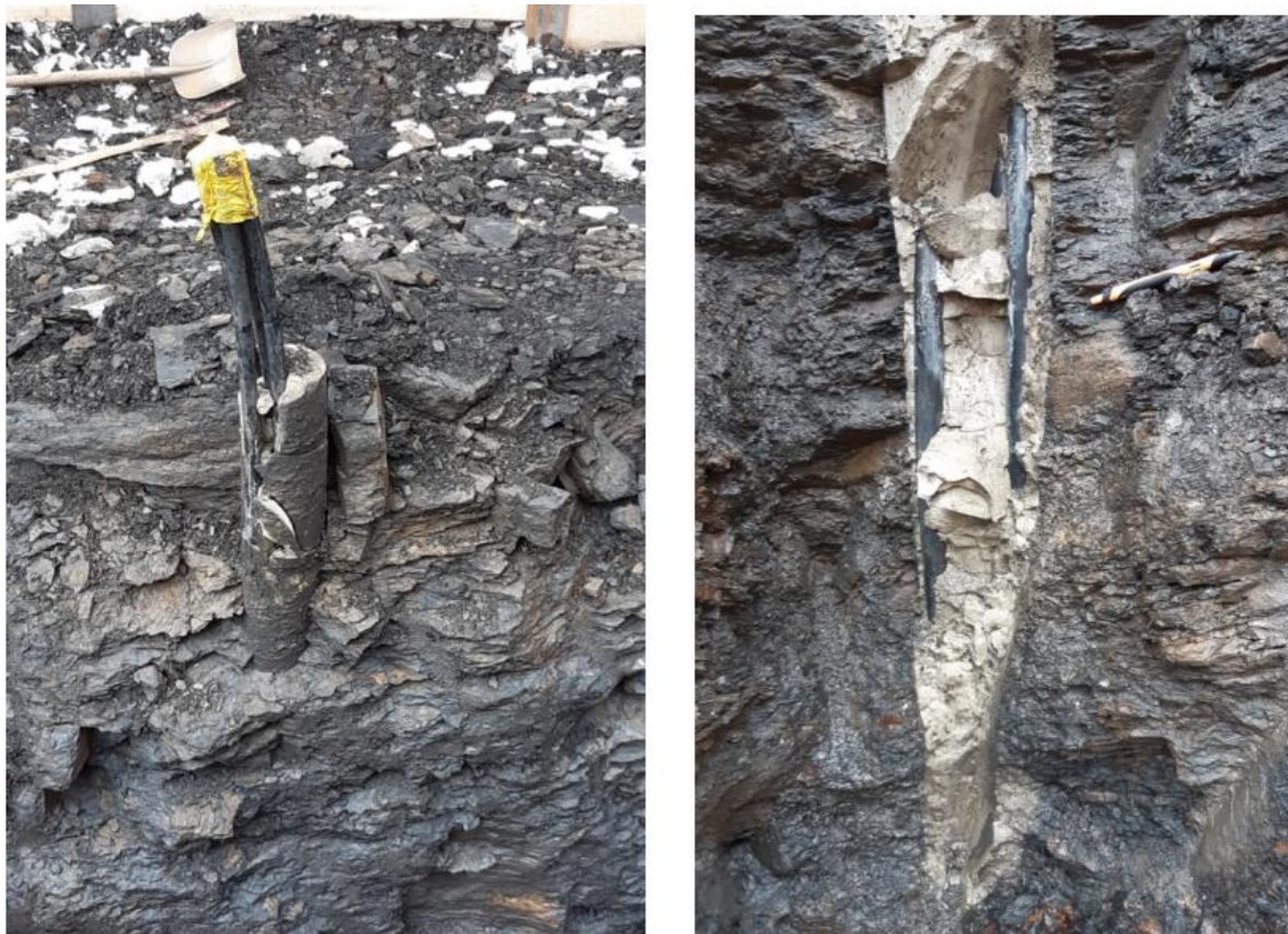
Obr. 1 Finální podoba zainjektovaného vrtu v horninovém prostředí. Fig. 1 Final configuration of a grouted borehole in the rock mass.
